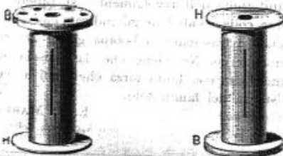
Fig. 8. — Due bobine di metallo destinate a svolgere la pellicola sensibile. Queste bobine sono poste in senso contrario l'una all'altra; le lettere H e B indicano l'alto e il basso.
