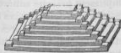
Fig. 245. — Trémie à base carrée formée par le chlorure sodique cristallisé par évaporation.
