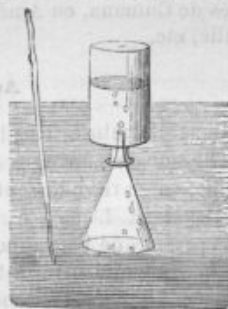
Fig. 77. — Flacon muni d'un entonnoir pour l'extraction du gaz inflammable de la vase des marais.
