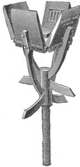
FIG. 47. — Moule à verges et piston (MORANE aîné).
