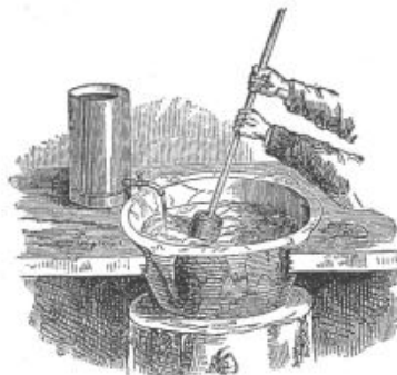
FIG. 77. — Versoir et mortier pour la fabrication des émulsions.
