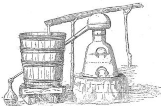
FIG. 16. — Appareil distillatoire employé en Bulgarie, d'après Blondel.
