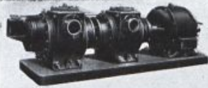
POMPE A VIDE Type 2400 Jumelées à commande électrique directe
