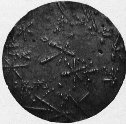
Fig. 36. — Alliage à 80,33 o/o d'étain, 11,11 o/o d'antimoine et 5,5 o/o de cuivre, après simple polissage. Cristaux étoilés de \text{SnCu}_3 .
