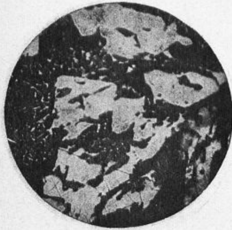
Fig. 34. — Alliage contenant 70 o/o de plomb, 10 o/o d'étain et 20 o/o d'antimoine.
