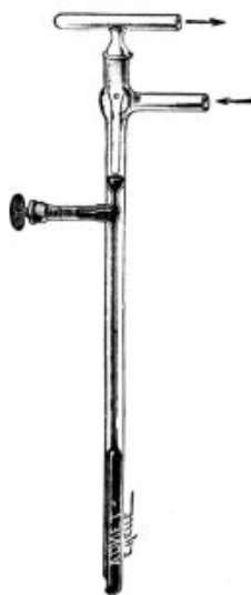
FIG. 7. — Régulateur à mercure de CHANCEL.
