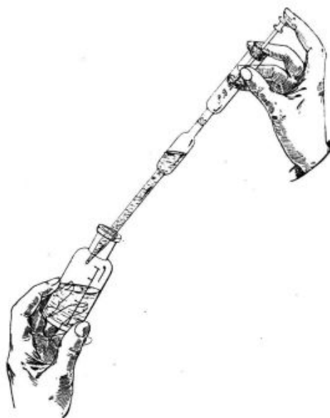
FIG. 2. — Fonctionnement de la pipette-pompe.
