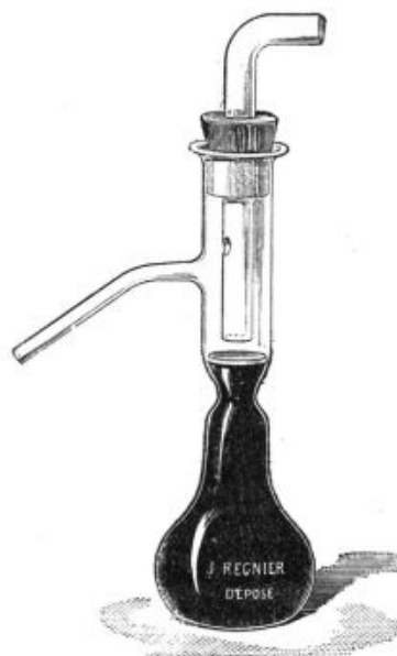
FIG. 3. — Régulateur de température pour étuve à fermentation.
