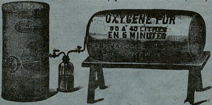
La fabrication de l'Oxygène par l'Oxylithe (peroxyde de sodium), étant identique à la fabrication de l'acétylène par le carbure de calcium, nous avons pensé être utile aux confrères en fabriquant un petit appareil théoriquement semblable au "Foyer", pouvant donner 30 litres d'oxygène.
