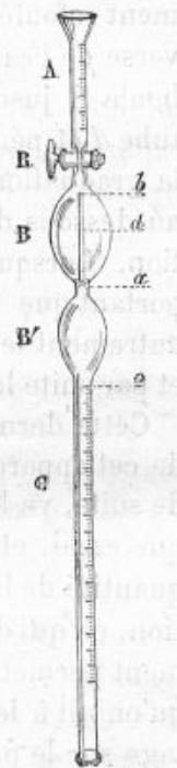
*Mode opératoire.* — Le robinet étant ouvert, on plonge l'instrument dans une éprouvette pleine d'eau jusqu'à ce que le niveau intérieur de cette eau affleure en a, on ferme
