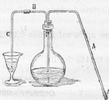
deux trous dans chacun desquels s'engage un tube. Le premier A deux fois recourbé a une de ses extrémités plongeant au fond du ballon. L'autre extrémité est fermée au moyen d'un tube en caoutchouc bouché par un morceau d'agificateur.
