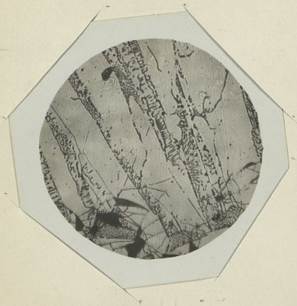
Fig XI Si = 51.12 attaque par HF G = 85 d
