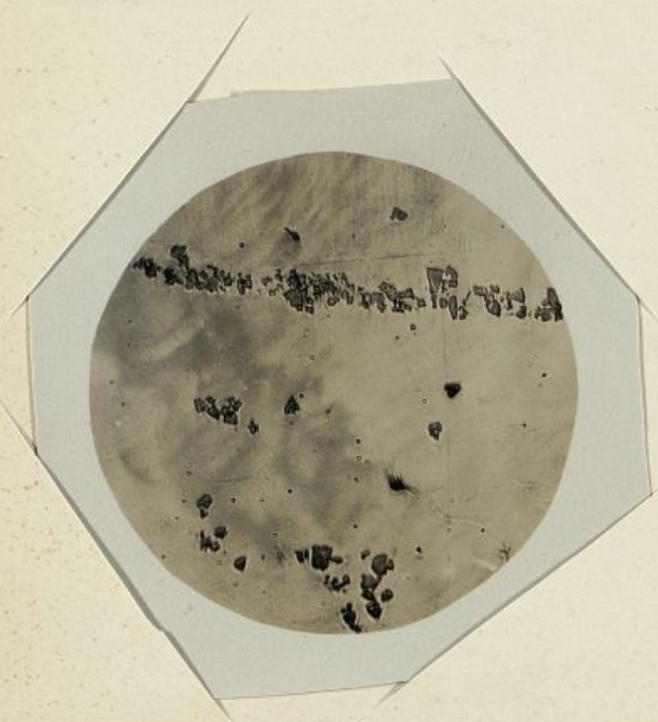
Fig III N° 1026 Si 48.87 Surface polie non attaquée G = 85d
