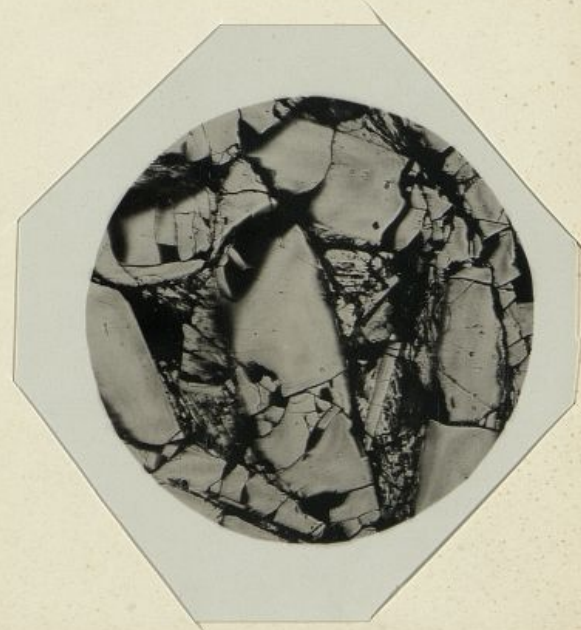
Fig IV N° 1027 Si 50.4 % attaque par HCl à 10 % G = 200d
