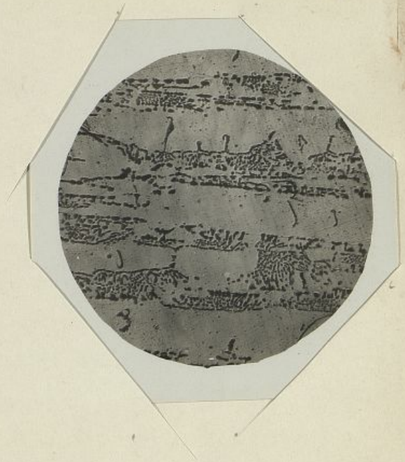
Fig X Si = 50 % attaque par HF G = 85 d
