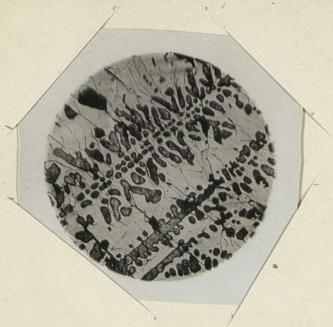
Fig V Si = 46.10 % attaque par HF G = 85 d
