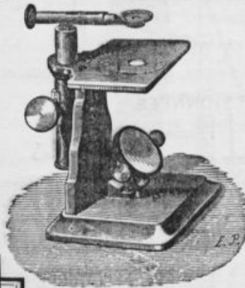
Microscope d'étudiant, avec pied en fonte vernie, colonne en cuivre, vis de rappel, tube à frottement, diaphragme variable, miroir concave, valets, loupe pour éclairer les corps opaques, un oculaire n° 1, deux séries 3 et 5 grossissant de 50 à 500 fois. Accessoires, boîte en noyer..... 100 fr.
