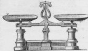
Fig. 1. Balance Roberval, socle en fonte, avec deux plateaux en cuivre.
