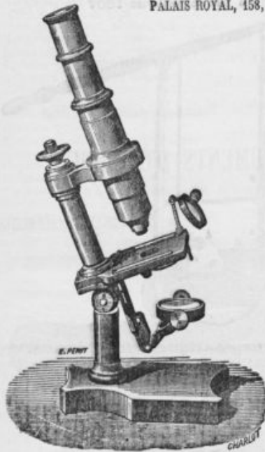
Microscope d'étudiant, avec pied en fonte vernie, colonne en cuivre, vis de rappel, tube à frottement, diaphragme variable, miroir concave, valets, loupe pour éclairer les corps opaques, un oculaire n° 1, deux séries 3 et 5 grossissant de 50 à 500 fois. Accessoires, boîte en noyer..... 100 fr.
