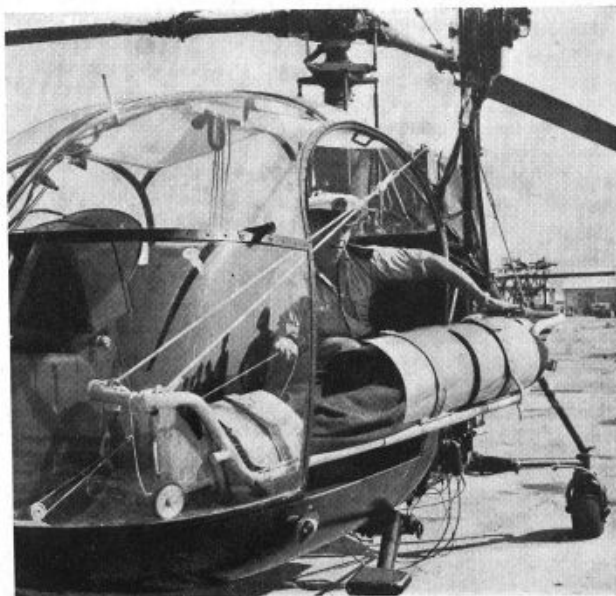
Entrée de la gouitière dans la cabine. Le pied de la gouitière, guidé par un câble, a roulé vers l'avant de la cabine
