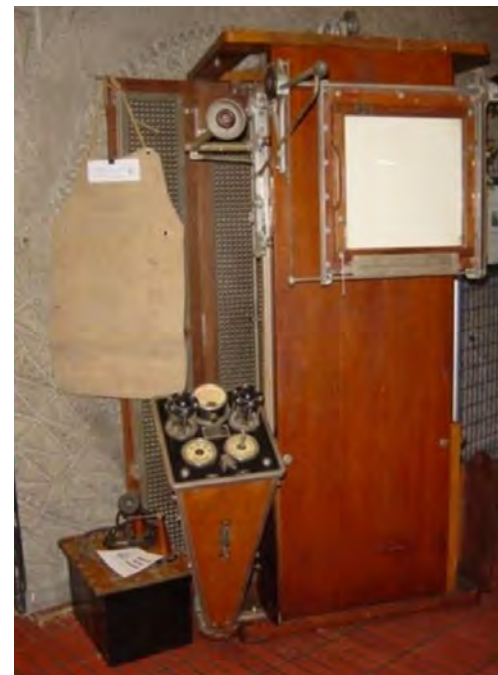
Fig. 14. Appareil de scopie, par émission de rayons X sur « plaque-écran » (1920). Cet appareil en bois, fabriqué par « Rapiquet, Hazart et Roycourt, Avenue Orléans 71, Paris. Usine à Amiens », comprend un pupitre de commande démontable et un écran avec une plaque fluorescente. Après la découverte de la radiographie par Röntgen en 1895, il n'avait fallu que deux ans pour voir apparaître la radioscopie, sous la forme d'une « plaque-écran » à base de fluor, utilisée pour la première fois par Antoine Béclère en 1897 à l'Hôpital Tenon. Dans la première moitié du XX e siècle, la radioscopie du thorax était surtout utilisée dans le dépistage de la tuberculose. Les appareils de radioscopie étaient présents dans les hôpitaux, mais aussi dans certains cabinets médicaux de ville.
