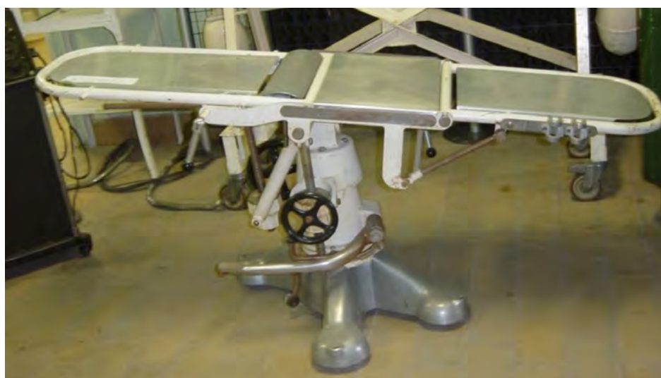
Fig. 20. Table de bloc opératoire (vers 1950). Ce type de table de bloc opératoire, pivotante et pliable, a été longtemps utilisé dans les hôpitaux et les cliniques. Alors qu'elles étaient précédemment en bois, avec possibilité d'adapter des étriers gynécologiques, c'est Jules Péan (1830-1898) qui mit au point en 1892 la première table métallique avec pilier central, plateau réglable en hauteur et trois parties inclinables. Ce n'est qu'à partir de 1957 que la table électrique Maquet permettra, grâce à ses articulations, d'adapter les différentes positions opératoires, ce qui constitua un grand progrès 11 .
