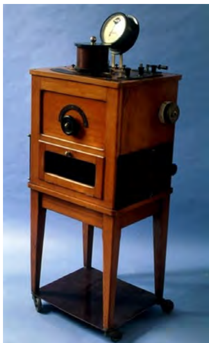
Fig. 14. Appareil de scopie, par émission de rayons X sur « plaque-écran » (1920). Cet appareil en bois, fabriqué par « Rapiquet, Hazart et Roycourt, Avenue Orléans 71, Paris. Usine à Amiens », comprend un pupitre de commande démontable et un écran avec une plaque fluorescente. Après la découverte de la radiographie par Röntgen en 1895, il n'avait fallu que deux ans pour voir apparaître la radioscopie, sous la forme d'une « plaque-écran » à base de fluor, utilisée pour la première fois par Antoine Béclère en 1897 à l'Hôpital Tenon. Dans la première moitié du XX e siècle, la radioscopie du thorax était surtout utilisée dans le dépistage de la tuberculose. Les appareils de radioscopie étaient présents dans les hôpitaux, mais aussi dans certains cabinets médicaux de ville.
