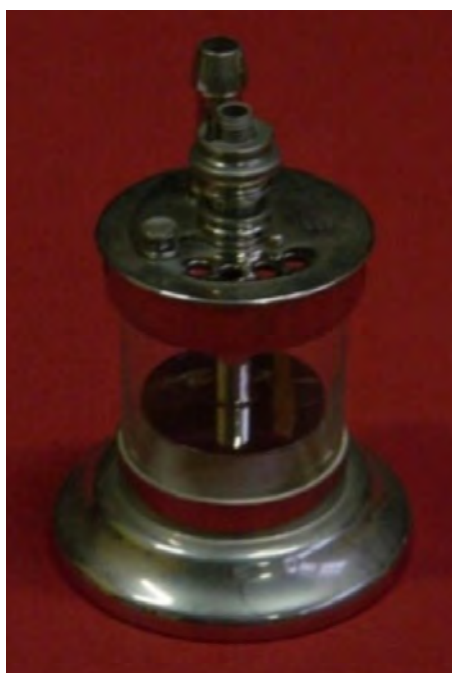
Fig. 9a et 9b. Chloroformisateur à soupape tournante de Ricard (1934). Créé en 1905 par le chirurgien français Alfred-Louis Ricard (1858-1932), cet appareil était fabriqué par les établissements Collin et fut largement utilisé en France jusque dans les années 1930. 4 Il comportait une valve pour contrôler le flux de vapeur. Une autre valve coulissante dans le couvercle réglait la concentration de la vapeur en ajustant la quantité d'air ajoutée. Un tuyau reliait l'ouverture située au sommet de l'inhalateur à un masque en caoutchouc.
