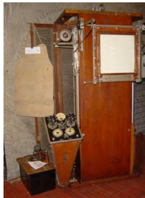
Fig. 13. Appareil néo-diathermique de Drapier, sur roulettes (1920) 7 . Il s'agit de l'un des premiers appareils électriques où l'on peut voir l'adaptation de l'électricité balbutiante au service de la médecine et de la chirurgie. Fabriqué en bois de merisier, il comprend une porte ouvrant sur un transformateur. Cet appareil permettait notamment la diathermie , procédé thérapeutique faisant pénétrer dans l'organisme une chaleur d'origine électrique par des courants alternatifs à haute fréquence, censé traiter certaines affections en gynécologie, en urologie, dans les maladies nerveuses, les affections articulaires, etc. Grâce à un commutateur, on pouvait aussi l'utiliser en mode effluvation , avec des décharges électriques destinées à soulager les douleurs musculaires. Acheté par le Musée hospitalier de Lille en 1996, il avait précédemment appartenu à M. Sosthène, qui avait été représentant des établissements Drapier à Tanger (Maroc).
