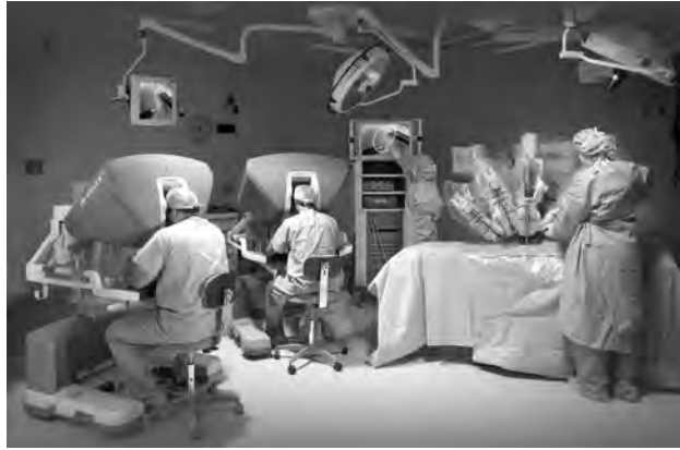
Fig. 2 - L'enseignement de la robotique grâce à deux consoles intégrant l'élève et le maître.
