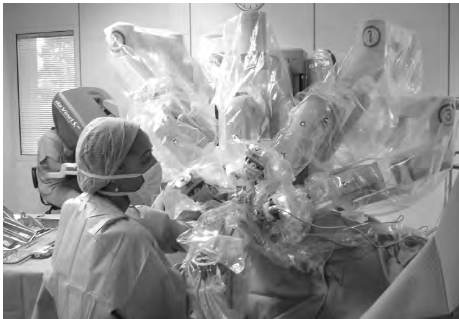
Fig. 1 - Le robot chirurgical Da Vinci ® comporte trois parties : console, instruments et informatique : c'est la disposition générale. Au premier plan la console du chirurgien, au second plan les instruments au-dessus de la table d'opération, et à droite les écrans de contrôle montrant la vision du champ opératoire.
